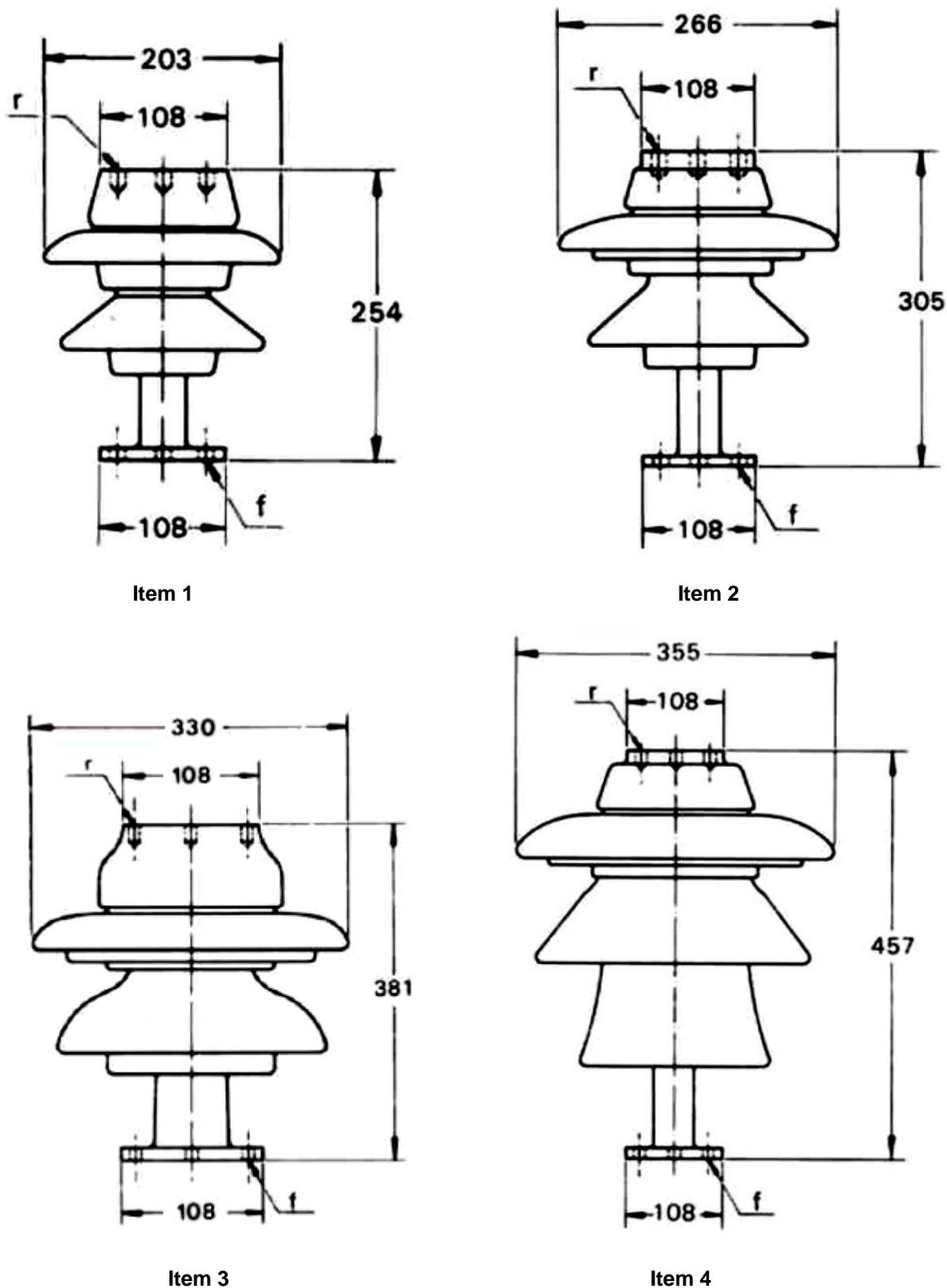
Figura 1 – Isolador Pedestal (Itens 1 ao 4)
